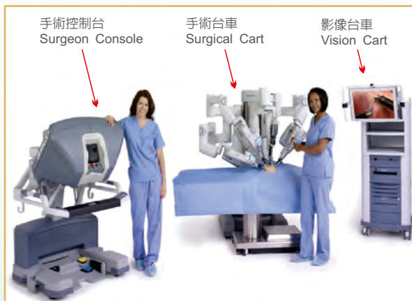
▲圖二、達文西手術的人體工學設計與系統架構
